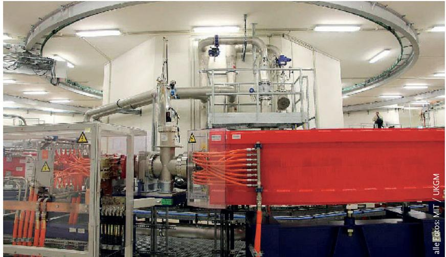
Die ringförmig angelegte Beschleunigeranlage (Synchrotron), in der die Partikel auf die therapeutisch erforderliche Energie beschleunigt werden
