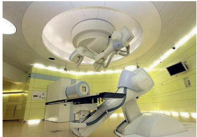
Blick in den Behandlungsraum mit robotergesteuertem Behandlungstisch, 3D-fähiger Röntgenbildgebung zur Lageverifikation und Auslass der Partikelstrahl-Führung (Nossel) an einem horizontal angelegten Behandlungsplatz
