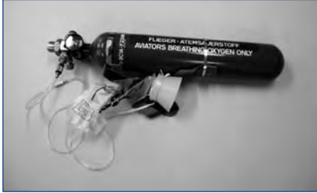
Abbildung 2: Zusatzsauerstoff an Bord, unabhängig von der Sauerstoffversorgung für Notfälle im Deckenbereich über jedem Sitz.
