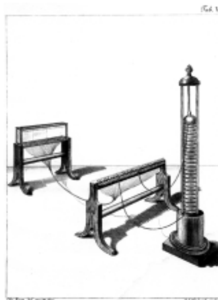
Soemmerrings elektrochemischer Telegraph, gezeichnet von seinem Maler Christian Koeck (1809). Tafel V aus der Schrift „Ueber einen elektrischen Telegraphen“ (1811).
